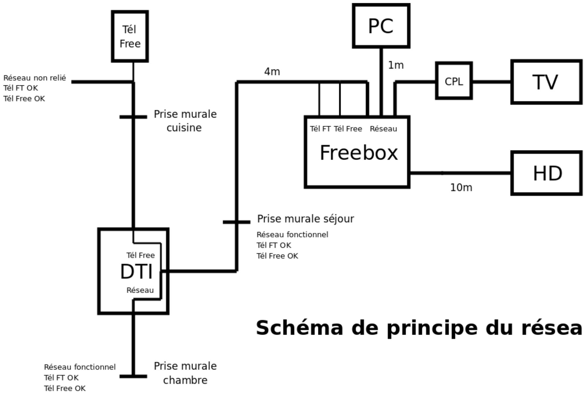
**Schéma de principe du réseau**
